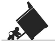
Il est possible pour la cuisinière de basculer vers l'avant et de causer des blessures et des dégâts si le support antibasculement n'est pas correctement installé. Ne pas faire fonctionner la cuisinière si le support antibasculement n'est pas en place.
