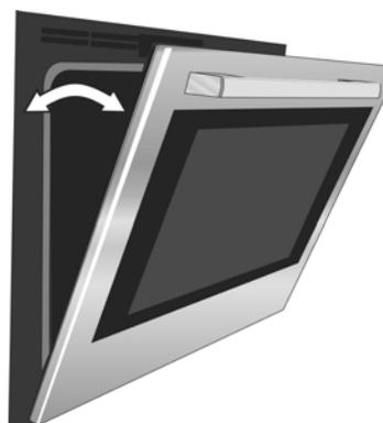
4. Fermer la porte du four jusqu'à ce qu'elle s'accroche sur les leviers d'arrêt des charnières, en bloquant les charnières à l'angle adéquat afin de pouvoir retirer la porte. La porte sera ouverte d'environ 7 po (178 mm) sur la partie supérieure. Ceci a pour effet d'éliminer la tension des ressorts exercée sur les charnières ce qui permet de soulever aisément la porte.
